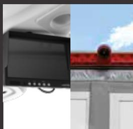
Monitor für Rückfahrkamera im Fahrerhaus + 3. Bremsleuchte mit integrierter Rückfahrkamera
