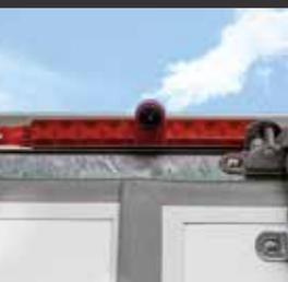
3. Bremsleuchte mit integrierter Rückfahrkamera
