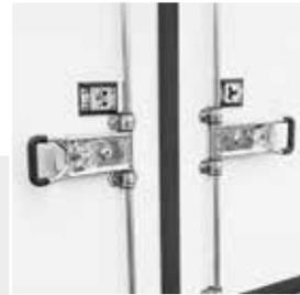
Doppelflügeltüre inkl. Drehstangenverschluss an beiden Türen
