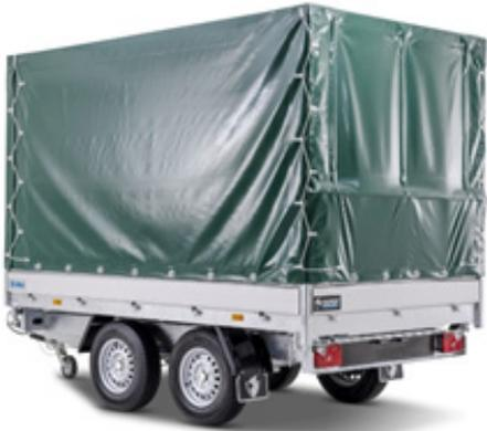
1. Bitte achten Sie vor dem Öffnen der Planenrollos darauf, dass sämtliche Verschlüsse gelöst werden: zuerst vertikal, dann horizontal!
