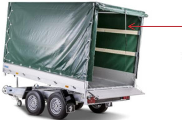
2. Die Plane muss gleichmäßig über das vorhandene Zuband geöffnet werden!
