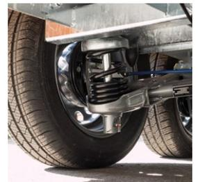
Das EquiDrive® PLUS S Schraubenfederfahrwerk
