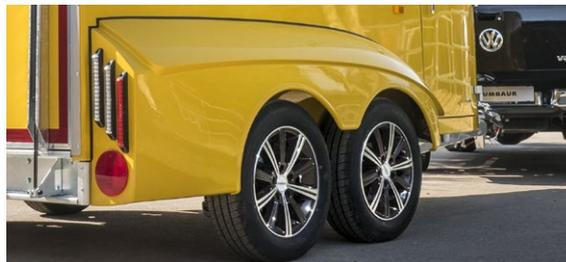
Design-Kotflügel mit LED-Beleuchtung und zweifarbigen Leichtmetallfelgen
