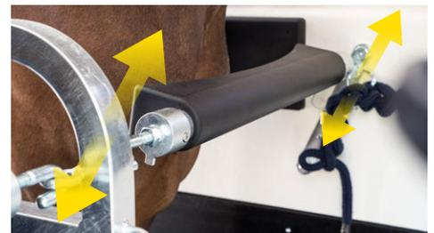
Die geteilten, gepolsterten und ausgeformten\* Brust- und Heckstangen können auf drei unterschiedlichen Ebenen und Tiefen **individuell eingehängt** werden.
