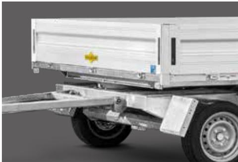
V-Deichsel mit gehärteten Stahlbolzen am Drehschemel montiert
