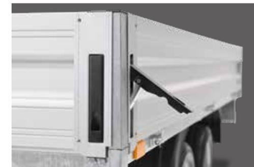
Klappe mit versenkten Verschlüssen
