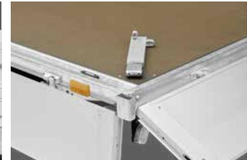
Abnehmbare Eckrungen bei abgeklappten Bordwänden
