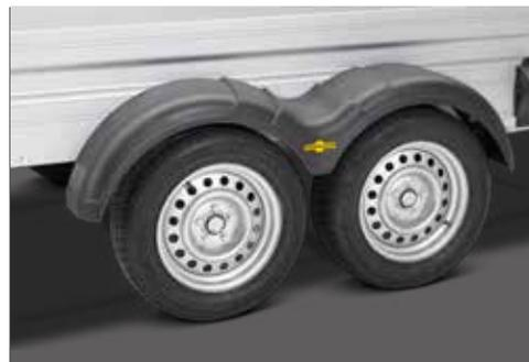
Aerodynamische Kotflügel aus Kunststoff
